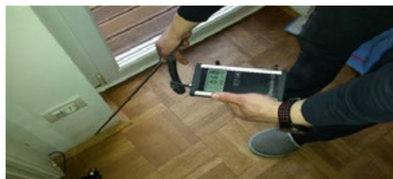
(87) Z anemometrom izmerimo lokalno hitrost gibanja zraka in poiščemo konvekcijske toplotne mostove.
