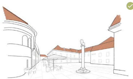
(31, 32) Običajne FN-naprave negativno vplivajo na enotno podobo strešnih površin niza stavb, ki obkrožajo glavni trg. FN-naprave naj se namestijo na strešine, ki niso vidne z javnih površin.
