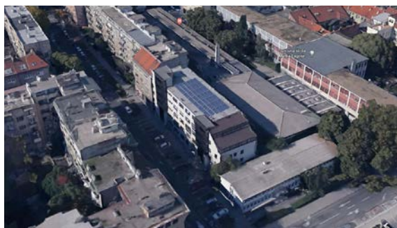
(71, 72) Primera FN-naprave na ravni strehi, sprejemljiva postavitev pravokotne oblike z odklikom od roba strehe (vir: Gradski zavod za zaščito spomenika kulture i prirode, Grad Zagreb, 2023)
