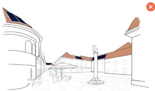
(31, 32) Običajne FN-naprave negativno vplivajo na enotno podobo strešnih površin niza stavb, ki obkrožajo glavni trg. FN-naprave naj se namestijo na strešine, ki niso vidne z javnih površin.
