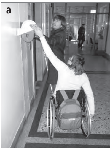
Slika 16: (a) Ob robu hodnika konzolno nameščen aparat za razvrstilne listke pomeni oviro na poti pri gibanju slepe osebe, manj primerna je tudi nameščenost, ki od sedečega zahteva dodaten napor; (b) neprimeren pult za poslovanje s strankami – njegovo polno pročelje onemogoča približanje, njegova višina pa komunikacijo; (c) primer primerne višine pulta za poslovanje s strankami, tudi pročelje pulta je vsaj delno umaknjeno v notranjost, kar osebi na invalidskem vozičku omogoča večje približanje.
