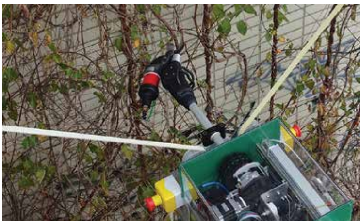
Slika 3.30: Škarje za obrezovanje med preizkusnim rezanjem (fotografija: Sebastian Schröder)
