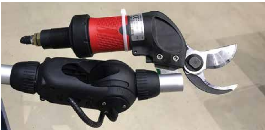
Slika 3.29: Škarje za obrezovanje, nameščene na robota (fotografija: Sebastian Schröder)
