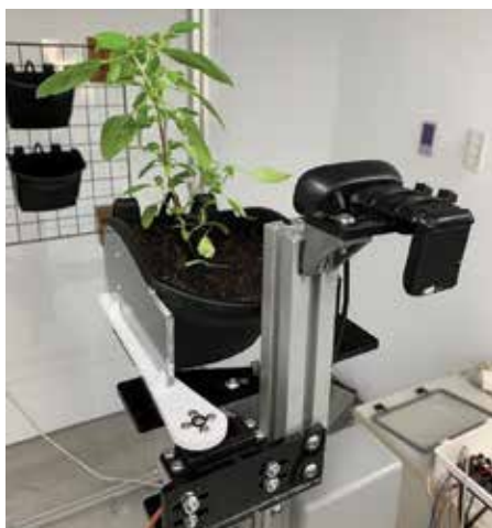
Slika 3.26: Postavitev zelene stene in portalnega mehanizma (levo, fotografija: Chung-Kee Yeh)
