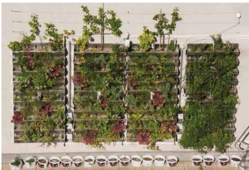
Slika 3.12: Preizkusna stena na Univerzi BOKU (od leve proti desni): nizka stopnja namakanja enkrat na teden (scenarij b), dnevno zalivanje (scenarij a) z vodovodno vodo, dnevno zalivanje (scenarij a) s sivo vodo, urno zalivanje (scenarij c) za čiščenje sive vode (fotografija: Irene Zluwa)
