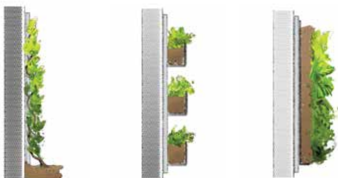
Slika 1.1: Zelene fasade z rastlinami, ki izraščajo iz tal (levo), žive stene s sistemom uporabe sadilnih posod (sredina) in žive stene (desno) (ilustracija: Bibi Erjavec)
