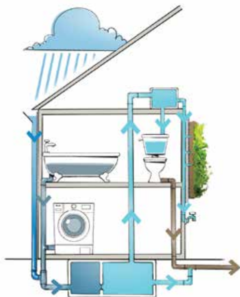
Slika 3.9: Shematski prikaz komponent za namakanje sistemov vertikalnih ozelenitev (ilustracija: Bibi Erjavec)
