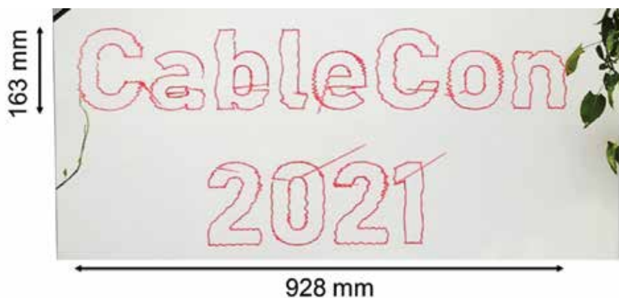
Slika 3.23: Besedilo kot primer natančnosti robota v smereh x in y (fotografija: Sebastian Schröder)
