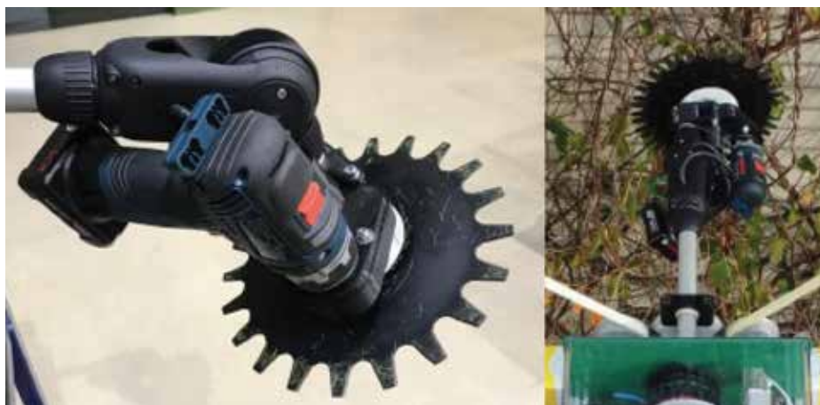
Slika 3.28: Spremenjena vrtljiva rezalna glava za rezanje tankih vej in listov (fotografija: Sebastian Schröder).
